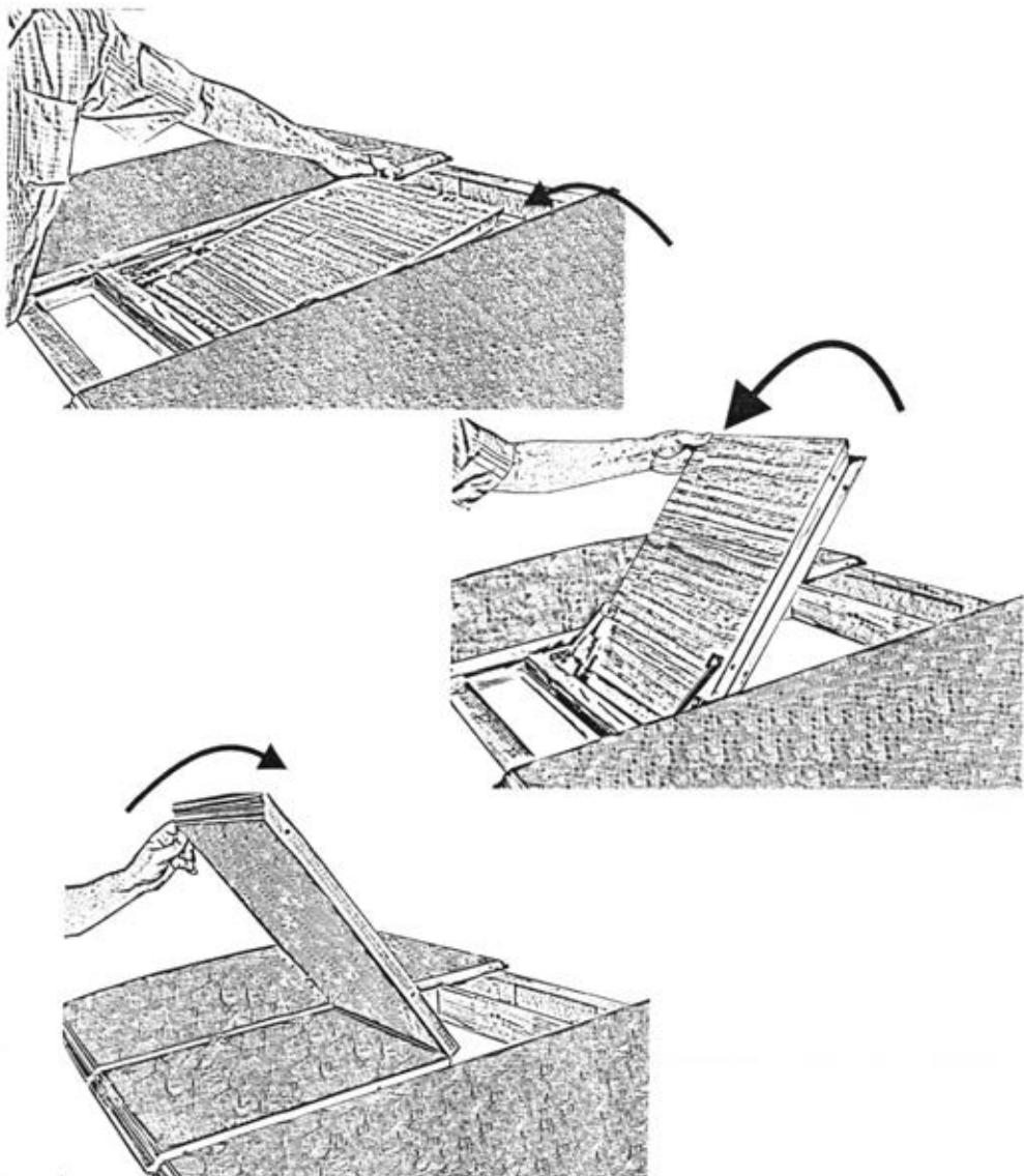
3. Сдвинуть полукрышки и состыковать их с вкладными досками при помощи металлических шкантов до упора. Закрыть стопор, обеспечив фиксацию полукрышек.
